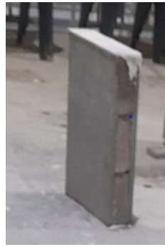
Figura 5. Prismas con bloques de hormigón.
